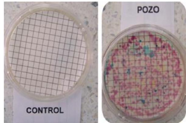
**Figura 4.** Muestra de control (izquierda) y presencia de E. Coli (derecha) en el agua utilizada para el consumo por la comunidad.
