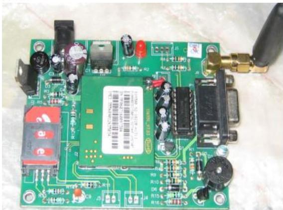
Figure6. SIMCOM 300 GSM modem
