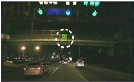
Fig 11. Detected traffic sign in poor environment 그림 11. 열악한 환경에서 검출된 표지판 영역
