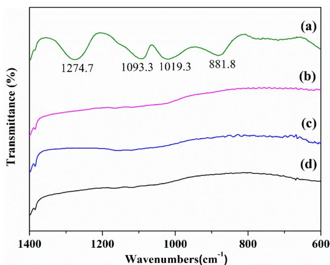
**Figure 8.** FTIR spectra of (a) SHMP; (b) SHMP + chalcopyrite +  $MgCl_2$ ; (c) SHMP + chalcopyrite +  $CaCl_2$ ; (d) chalcopyrite.
