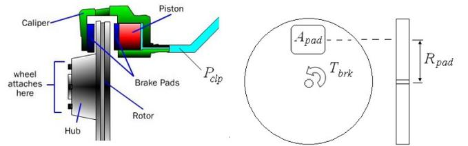
FIGURE 2. SCHEMATIC OF THE DISC BRAKE
