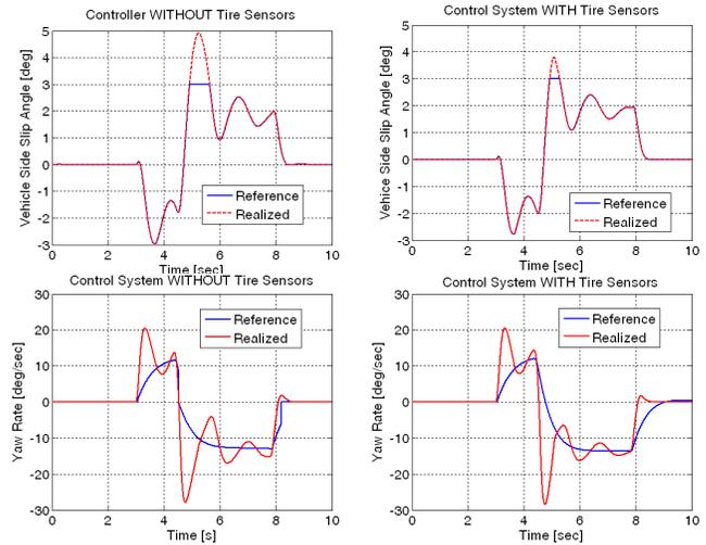
FIGURE 11. LOAD ADAPTIVE SYSTEM PERFORMANCE
