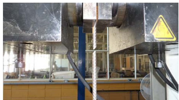
(b) Ruptura da barra de aço
