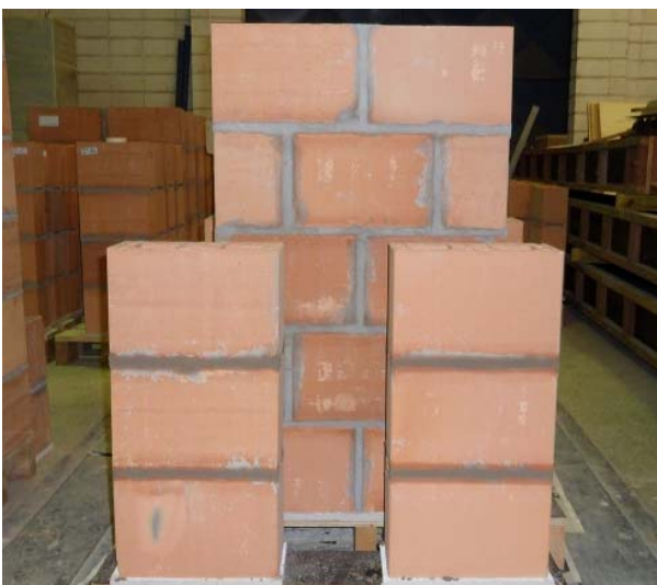
(a) Prisma de 3 blocos e pequena parede
