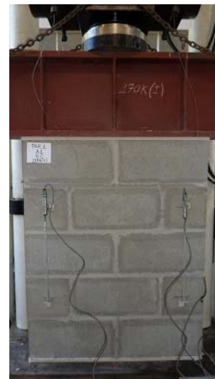
(b) Pequenas paredes de blocos de concreto
