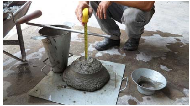
(b) Ensaio de abatimento do graute
