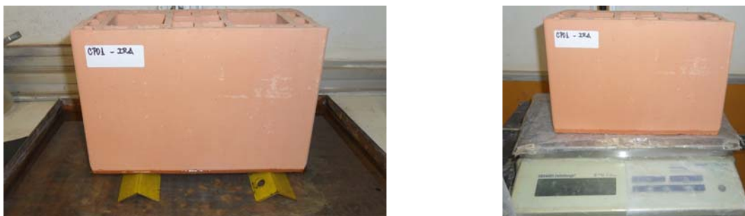
Figura 3.10 – Ensaio para determinação do índice de absorção inicial de blocos cerâmicos.
