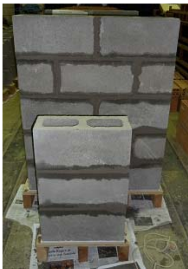
(a) Prisma de 3 blocos e pequena parede
