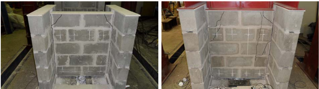
(a) Padrão de fissuração
