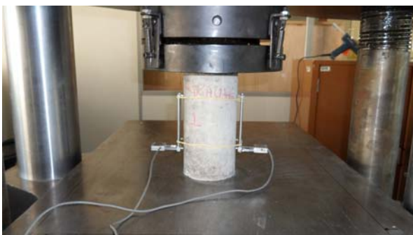
(a) Resistência à compressão
