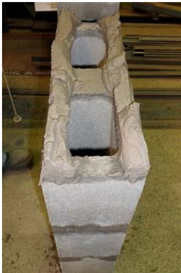
(a) Detalhe do argamassamento parcial
