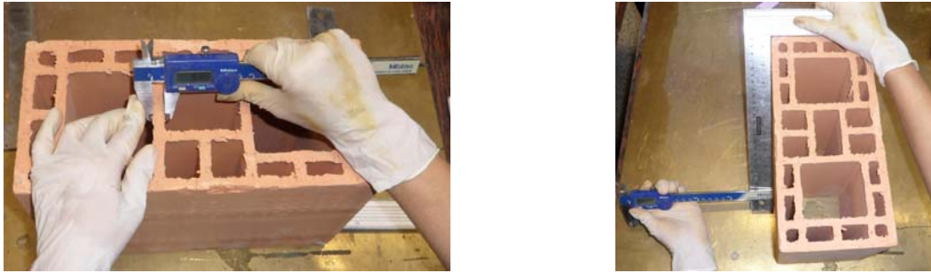
Figura 3.6 – Determinação da espessura das paredes externas e dos septos, e verificação da planeza das faces dos blocos cerâmicos.
