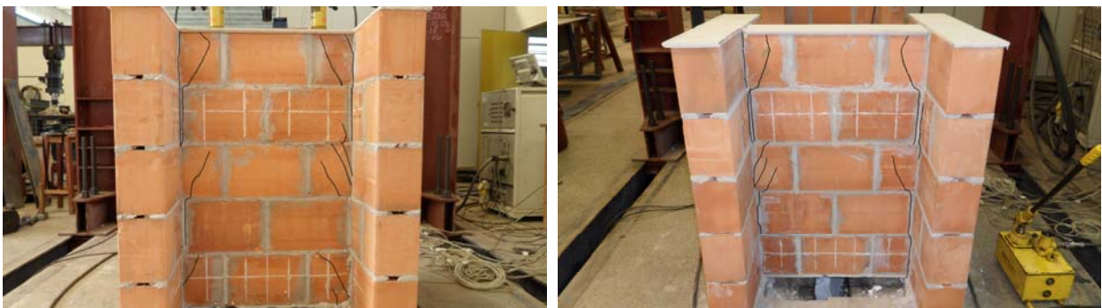
Figura 4.34 – Padrão de fissuração dos modelos da Série II – parede central.
