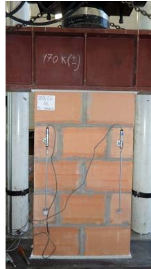
(b) Pequenas paredes de blocos cerâmicos
