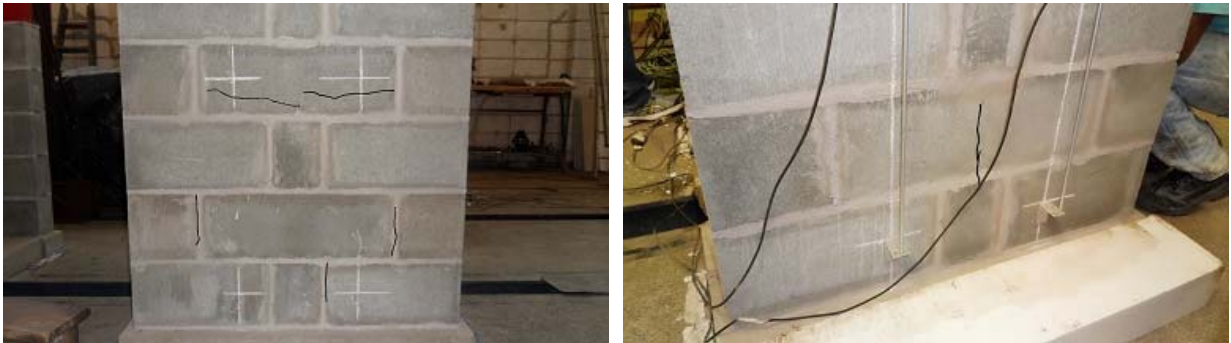
Figura 4.31 – Padrão de fissuração dos modelos da Série I – flanges.
