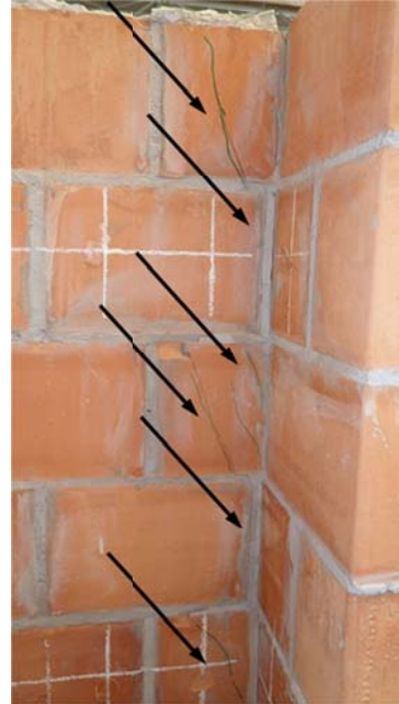
(a) Tensões de cisalhamento nos blocos b) Fissuras de cisalhamento na interface Figura 5.21 – Tensões de cisalhamento \sigma_{zx} nos elementos dos blocos e fissuras no modelo físico.
