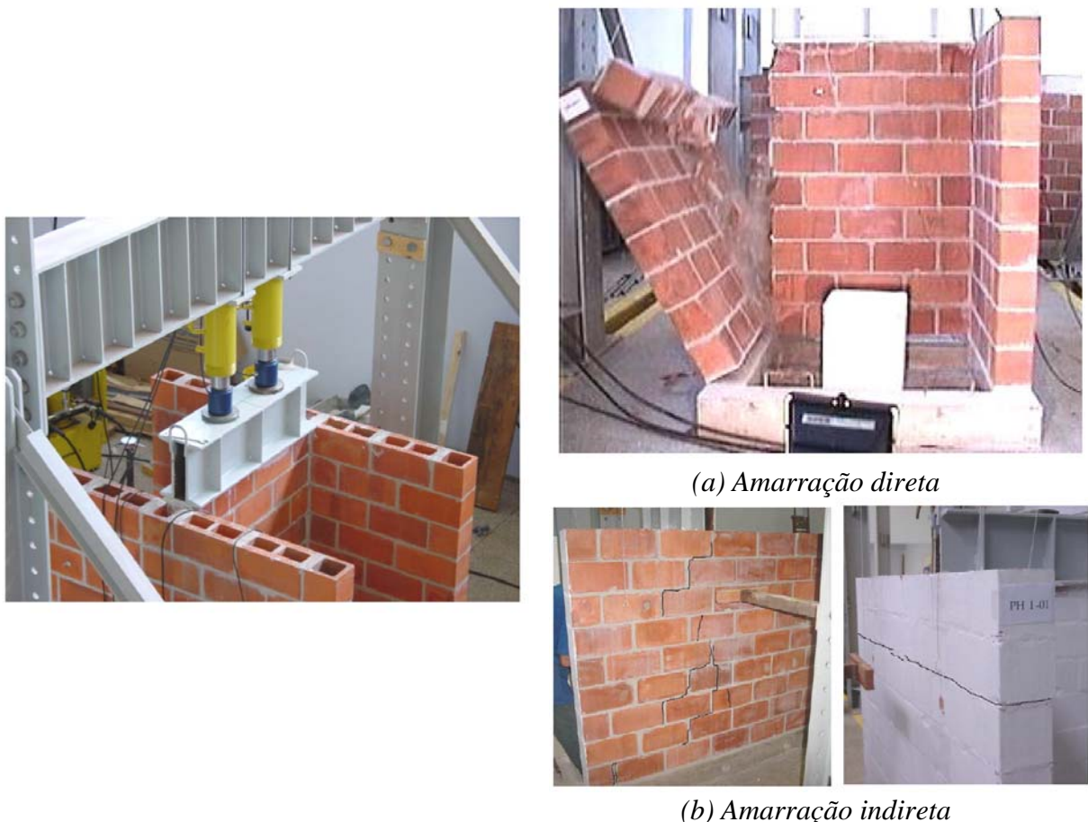
Figura 2.29 – Esquema de carregamento e formas de ruptura (SILVA, 2003).
