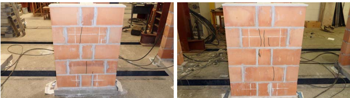
Figura 4.36 – Padrão de fissuração dos modelos da Série II – flanges.
