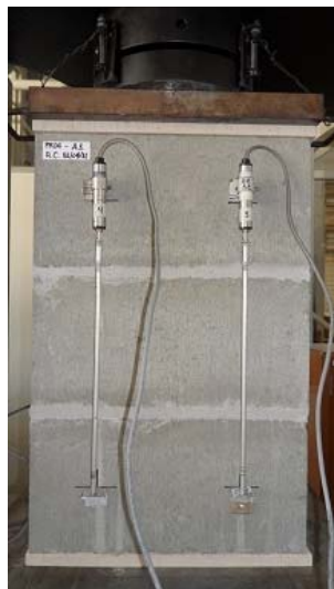
(a) Prismas de blocos de concreto
