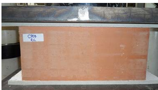
Figura 3.28 – Modo de ruptura dos blocos especiais cerâmicos de 440 mm de comprimento.
