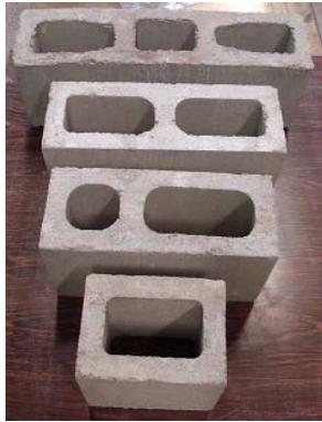
a) Blocos de concreto
