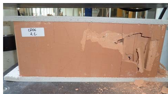
Figura 3.28 – Modo de ruptura dos blocos especiais cerâmicos de 440 mm de comprimento.
