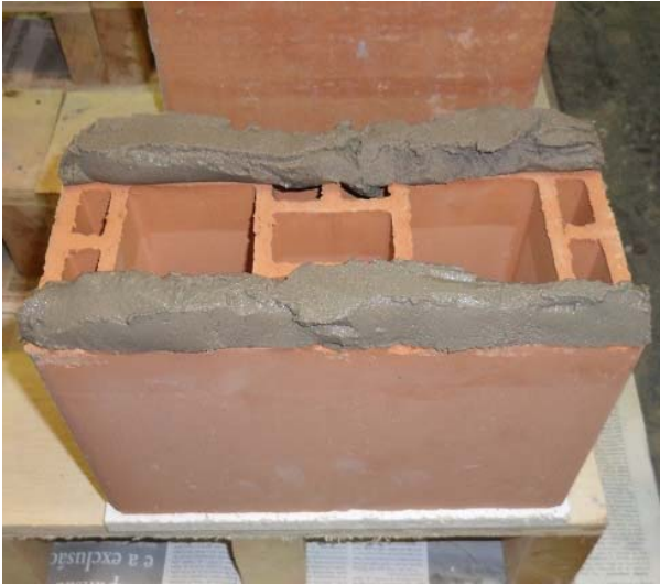
(a) Detalhe do argamassamento parcial
