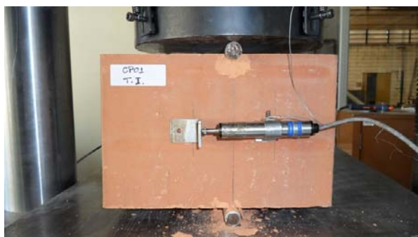
Figura 3.29 – Primeira tentativa de apoio para o ensaio de resistência à tração indireta dos blocos cerâmicos.
