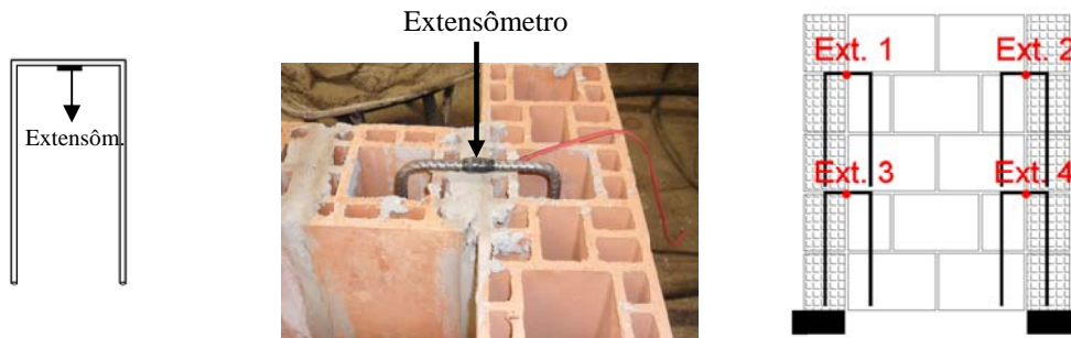
(a) Posição do extensômetro (b) Posição do grampo (c) Numeração dos extensômetros Figura 4.23 – Instrumentação interna para Séries III e IV.
