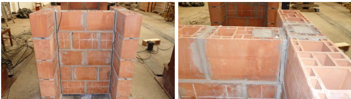
(a) Padrão de fissuração (b) Movimento de corpo rígido Figura 4.46 – Padrão de fissuração dos modelos da Série IV – parede central e detalhe de movimento de corpo rígido.
