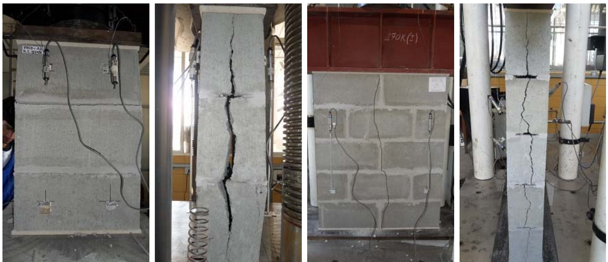
(a) Prismas de blocos de concreto
