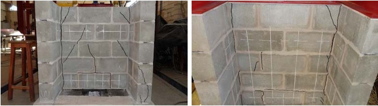
Figura 4.29 – Padrão de fissuração dos modelos da Série I – parede central.
