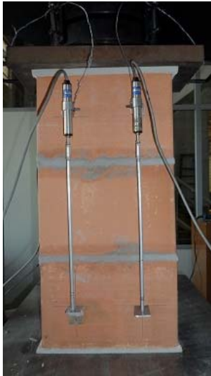
(a) Prismas de blocos cerâmicos
