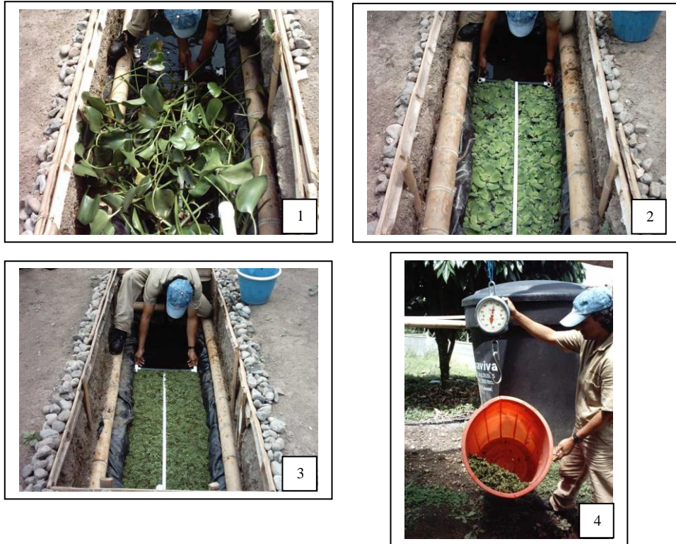
Figura 3.13. Densidad operacional de las macrófitas flotantes. 1. Medición del 75% del área superficial para la siembra del Jacinto. 2. Medición del 75% del área superficial para la siembra de la Lechuga. 3. Medición del 75% del área superficial para la siembra de la Oreja de agua. 4. Determinación del peso de la Oreja de agua que cubrió el 75% del área superficial de la laguna.
