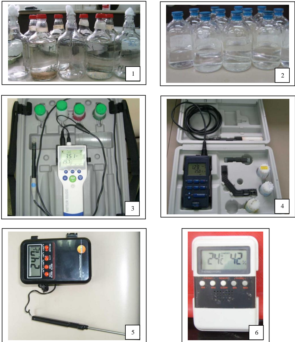
Figura 3.17. Elementos de muestreo y medición In Situ de las aguas residuales. 1. Botellas de vidrio de 770 ml utilizadas para el muestreo. 2. Botellas de vidrio esterilizadas de 65 ml de capacidad, utilizadas para el almacenamiento de las muestras destinadas para los diferentes análisis. 3. Equipo portátil utilizado en la determinación del pH. 4. Equipo portátil utilizado en la determinación del oxígeno disuelto. 5. Equipo portátil utilizado en la determinación de la temperatura. 6. Termohigrómetro utilizado para medir la temperatura y humedad relativa en el área de experimentación.
