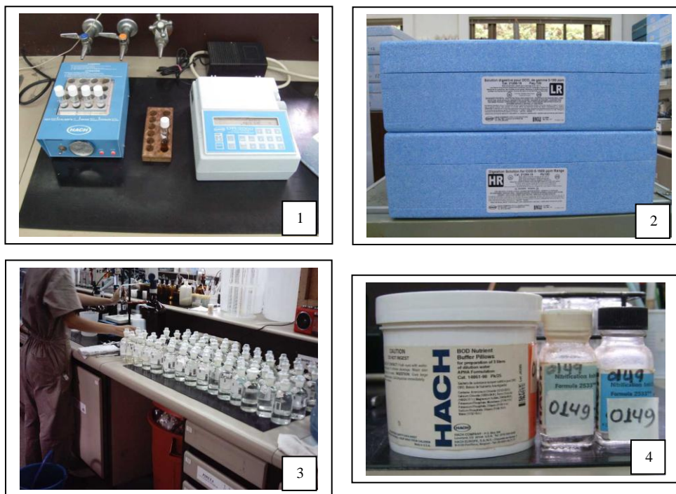
Figura 3.18. Caracterización físico-química de las aguas residuales. I. 1. Digestor y Espectrofotómetro utilizados en la determinación de la DQO. 2. Viales de bajo y de alto rango utilizados para la determinación de la DQO. 3. Determinación de la DBO_5 por el método de la dilución. 4. Nutrientes e inhibidor de la nitrificación utilizados en la determinación de la DBO_5 .
