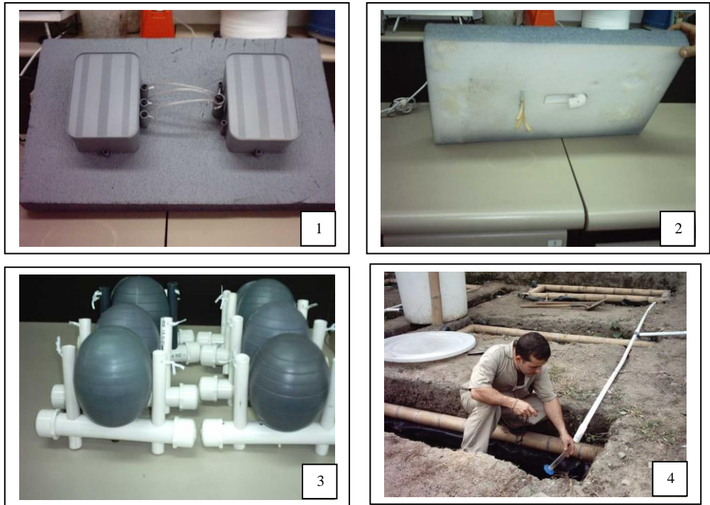
Figura 3.10. Regulación del caudal de alimentación a las lagunas de experimentación. 1. Flotador en icopor con 3 salidas. Vista superior. 2. Flotador en icopor con 3 salidas. Vista inferior (para afluentes sin diluir y diluidos al 40%). 3. Flotador plástico con accesorios en PVC (afluentes diluidos al 10%). 4. Calibración de los flujos de alimentación.
