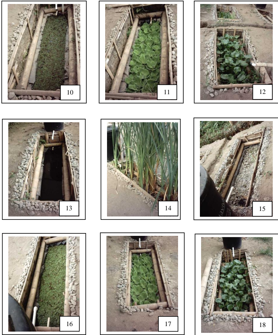
Figura 3.41. II. Aspecto de las lagunas al final del ensayo. 10. S. auriculata a C_{0,4} . 11. P. stratiotes a C_{0,4} . 12. E. crassipes a C_{0,4} . 13. Control Flotantes a C_{0,1} . 14. T. angustifolia a C_{0,1} . 15. Control Emergente a C_{0,1} . 16. S. auriculata a C_{0,1} . 17. P. stratiotes a C_{0,1} . 18. E. crassipes a C_{0,1} .
