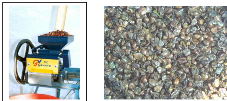
Figura 1.6. Despulpadora y pulpa obtenida del beneficio del fruto.
