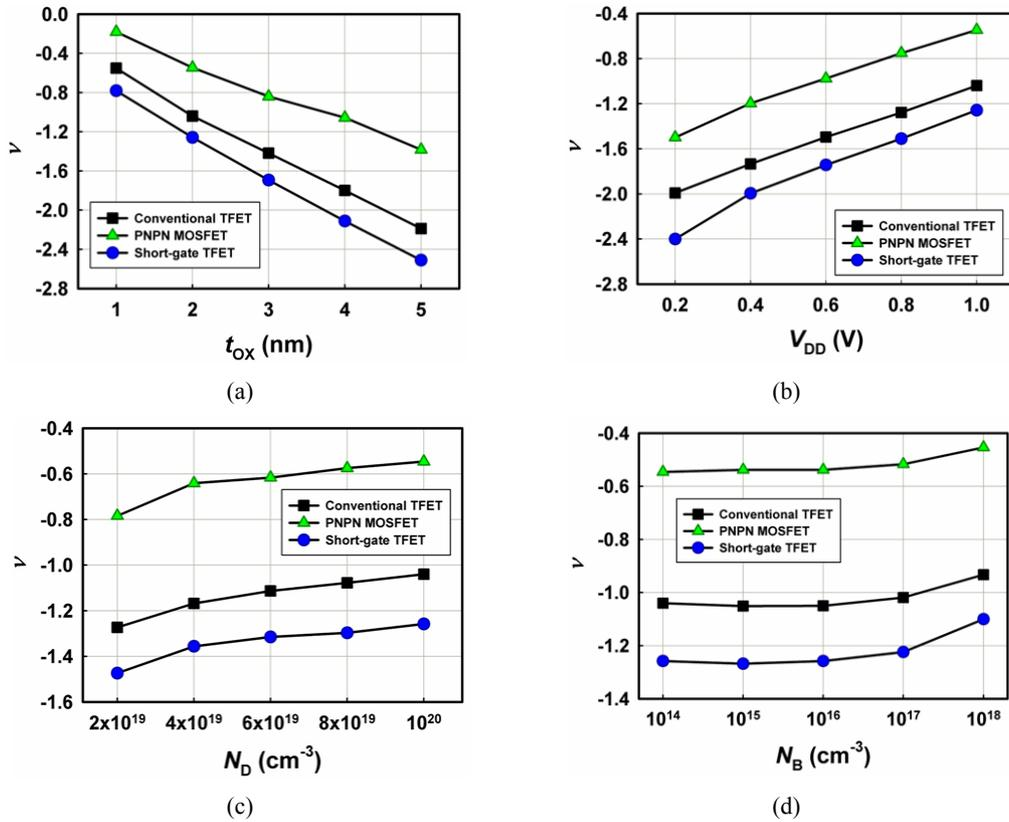
Fig. 6. The effect of (a)  $t_{ox}$ , (b)  $V_{DD}$ , (c)  $N_D$ , (d)  $N_B$  on  $\nu$ .
