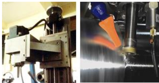
Gambar 2: Sistem pahat putar dan perangkat vortex tube pada mesin bubut
