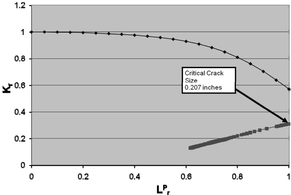
FIGURE 1 – FAILURE ASSESSMENT DIAGRAM FOR TUBE – INFINITE RADIAL – LONGITUDINAL CRACK
