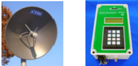
写真-1 (左)発信器付パラボラアンテナ (右)出力記録器
