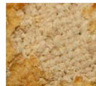
Fig. 16 y 17. Macrofotografía de fibras de la tela de refuerzo del reverso de la pintura arrancada, con restos de caseinato cálcico.
