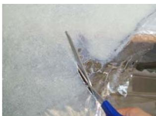
Fig. 166. Processo di taglio della fibra di vetro già polimerizzata che eccede del perimetro segnato.
