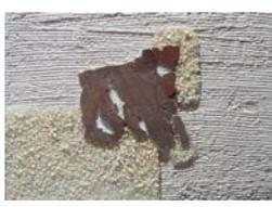
Fig. 95. Pintura adherida al nuevo soporte al que se le ha aplicado una capa de árido con resina acrílica para favorecer el agarre del mortero de estucado para la posterior reintegración.
