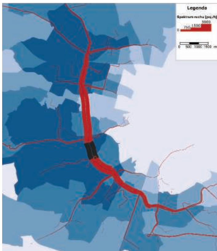
7. Wariant W1 (ZPŁ) – spektrum (wiązka) ruchu drogowego w przekroju Mostu Pychowickiego po ukończeniu 3. etapu III obwodnicy (Trasy Zwierzynieckiej)
