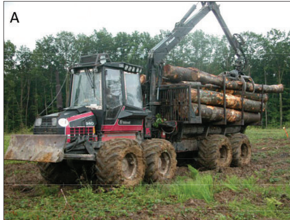
FIGURE 6 RÉALISATION DU TASSEMENT PAR LE PORTEUR VALMET DE L'ENTREPRISE LECOMTE SUR LE SITE D'AZERAILLES (A), ET RÉSULTAT DU TASSEMENT SUR LE SOL APRÈS UN PREMIER PASSAGE (B) ET UN SECOND DÉCALÉ D'UNE DEMI-LARGEUR DE PNEUMATIQUE, DE FAÇON À COUVRIR AU MIEUX TOUTE LA SURFACE ET RÉSORBER LES BOURRELETS (C)
