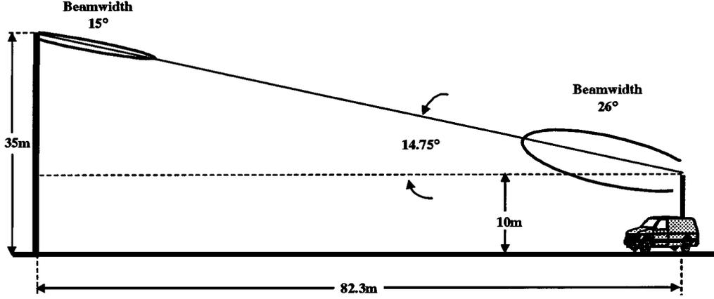
Fig. 12. Daily calibration site arrangement.
