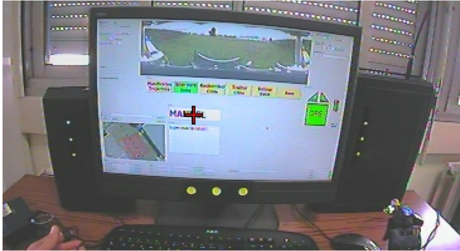
Figure 14. Interface de contrôle du robot : l'opérateur humain est équipé d'un oculomètre qui permet de déterminer les directions du regard à partir de la position de la croix rouge. Dans cet exemple, l'opérateur humain est focalisé sur le mode de pilotage « manuel ».
